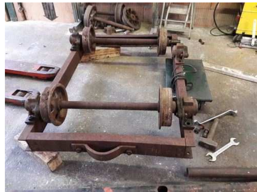
Abb. 9+10: Original-Fahrgestellteile und Achsen
